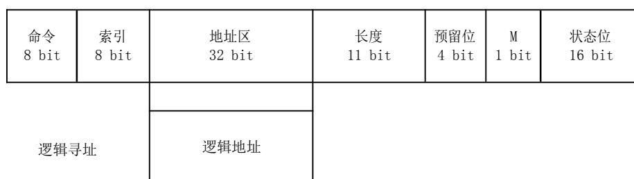
EtherCAT 逻辑寻址结构
